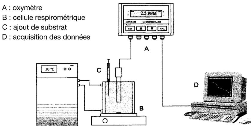
**Figure 1** Système respirométrique utilisé pour l'évaluation du  $r_{O_2N}$  max.
