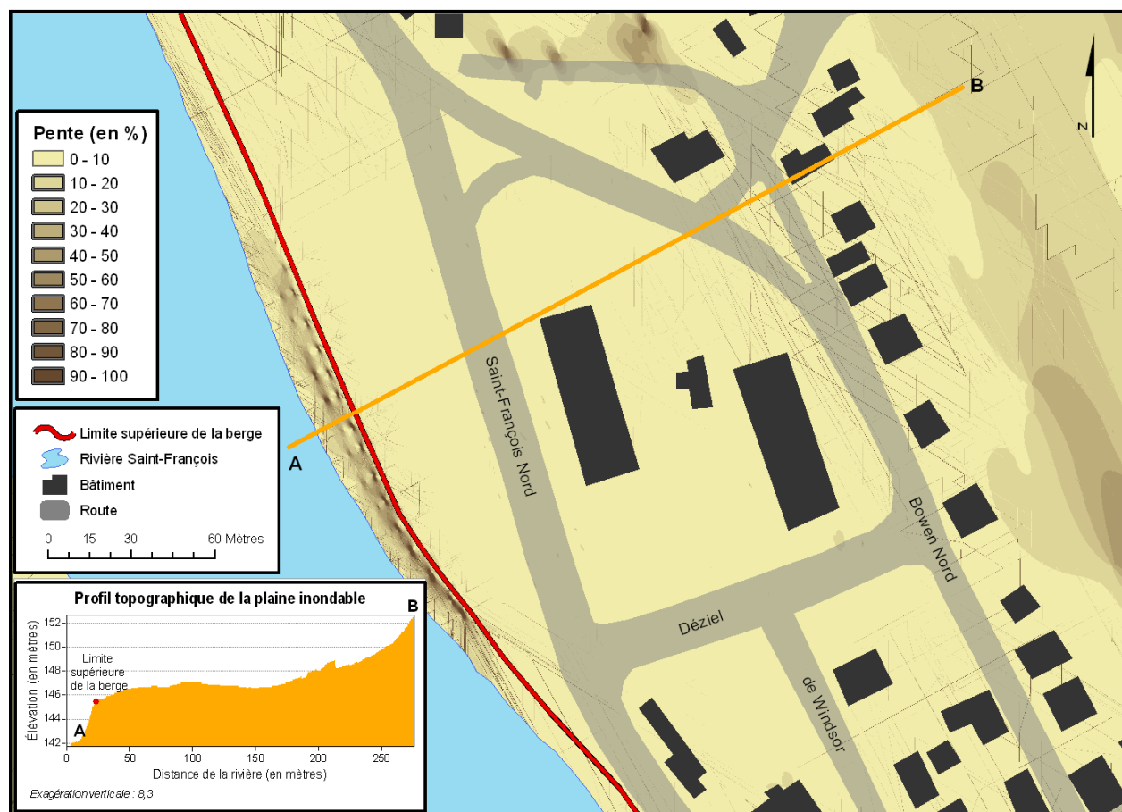
Fig. 6 — Les pentes et la localisation de la limite supérieure de la berge (Site SHE-2)
