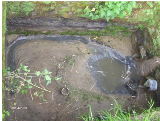
Figure 10. Vue du colmatage des filtres par la formation d'une couche de boue. View of filters clogging by the formation of a mud layer.
