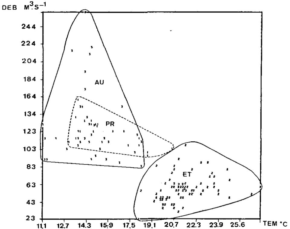
Figure 6.- Relation entre le débit de la Seine (DEB) et la température de l'eau à l'entrée du filtre (TEM).
