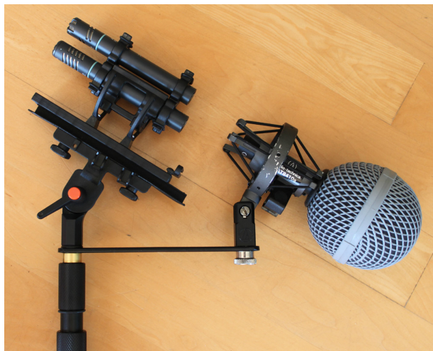
Figure 6 : Ensemble de microphones, à l'avant, une prise de son stéréo Mide/Side avec un AKG CK94 et CK91 ; à l'arrière, une prise en stéréo XY avec un Audio Technica BP4025. Photo : JAV.
