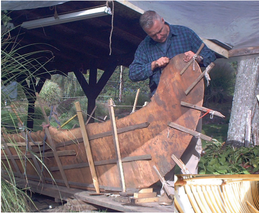
Étrave pincée pour permettre la ligature
