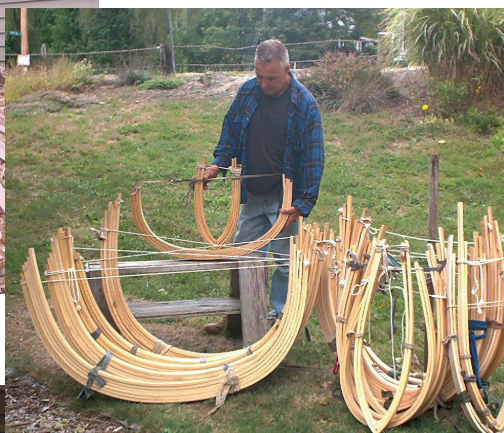
Varangues du rabaska comparées à celles d'un canot de taille ordinaire (tenues par Henri Vaillancourt)
