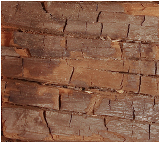
Figure 1. Carie brune cubique causée par S. lacrymans . Le bois est brun et craquelé. Spécimen QFB-2758.
