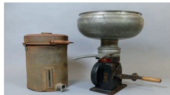
À gauche, une écrémeuse en fer-blanc, don de Fernand Ste-Croix et à droite, une écrémeuse de type centrifuge manuelle, de la marque suédoise The Laval Company et qui date de 1920 approximativement, don de Jean-Charles Duguay. Musée de la Gaspésie
