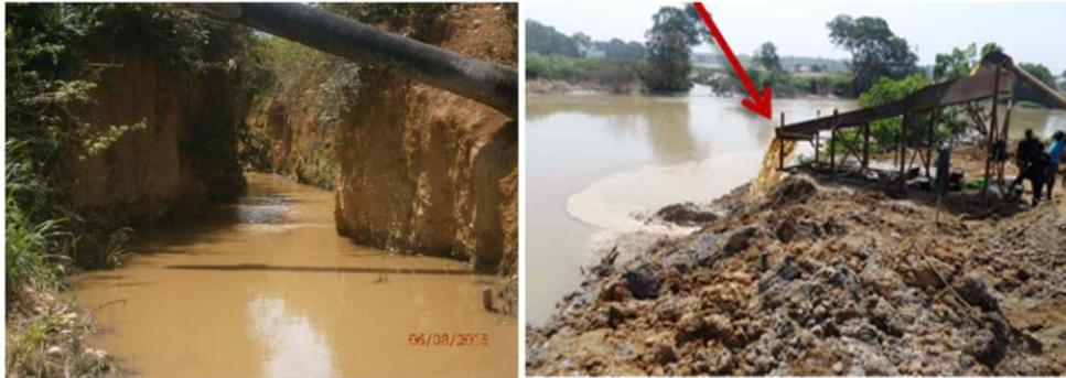
À gauche, canalisation et détournement du lit de la rivière Ékali et à droite déversement dans le cours du Lom des déchets issus du lavage de minerais.
