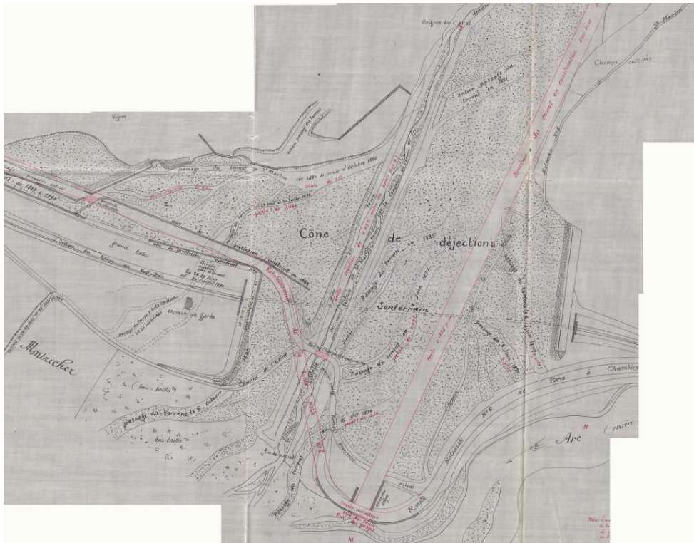
FIGURE 4. RECENSEMENT CARTOGRAPHIQUE DES LAVES TORRENTIELLES ET DES TRAVAUX DE CORRECTION, PLAN TERRIER AU 1 : 1000 (90 CM X 150CM) / MAPPING OF DEBRIS FLOWS AND CORRECTION WORKS, MAP 1:1000 (90 CM X 150CM).
