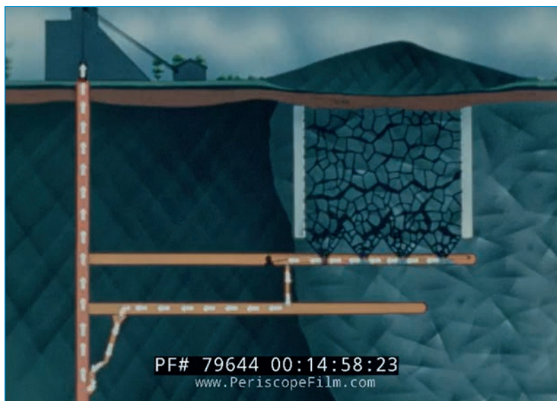
ILL. 19. IMAGE SCHÉMATIQUE EXPLIQUANT LA TECHNIQUE DE FOUROYAGE PAR BLOCS. PERISCOPE FILM LLC ARCHIVE.
