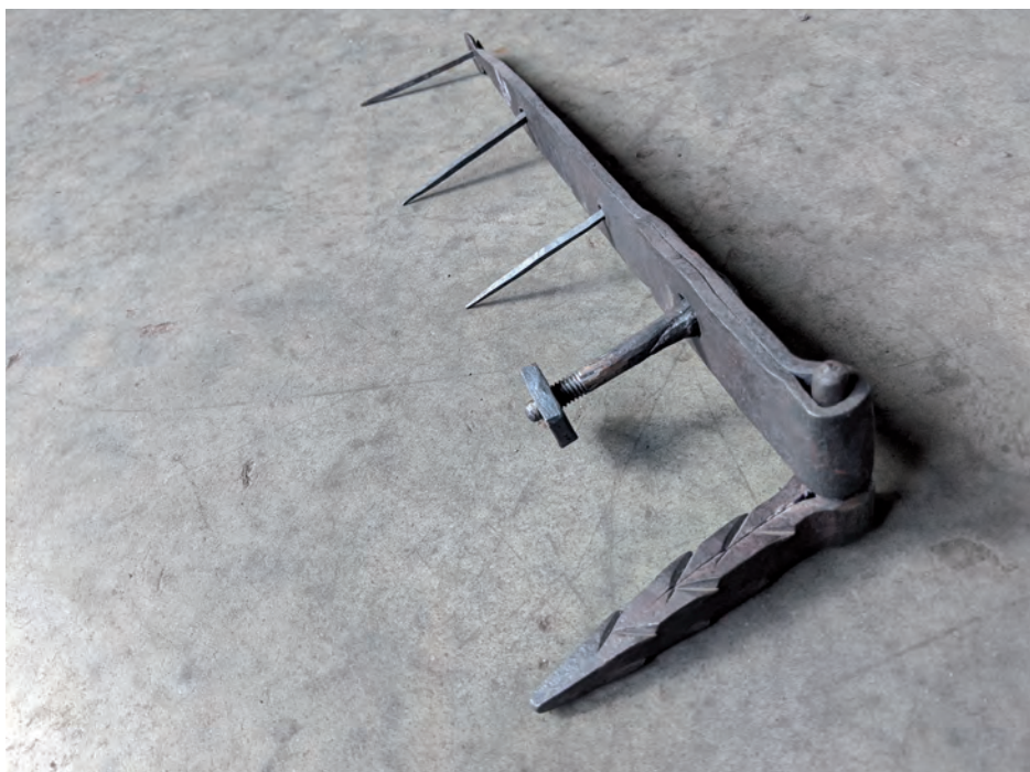
Reproduction de penture de porte traditionnelle en vieux fer. Cette pièce de quincaillerie a été réalisée comme support à la formation sur le sujet donnée en partenariat par Les Forges de Montréal et le Conseil des métiers d'art du Québec.
