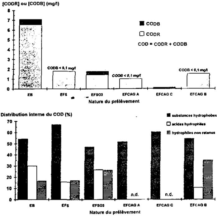
**Figure 4** Évolution des paramètres de caractérisation et de la distribution hydrophobe/hydrophile lors du traitement en usine de l'eau brute R8 (n.d. : non déterminé). (EB : Eau Brute ; EFS : Eau Filtrée Sable ; EFSO3 : Eau Filtrée Sable Ozonée ; EFCAG : Eau Filtrée sur Charbon Actif en Grain).
