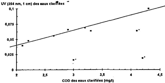
**Figure 1** Relation entre l'UV<sub>EC</sub> et le COD<sub>EC</sub> ; (\*) : point non pris en compte dans la corrélation.
