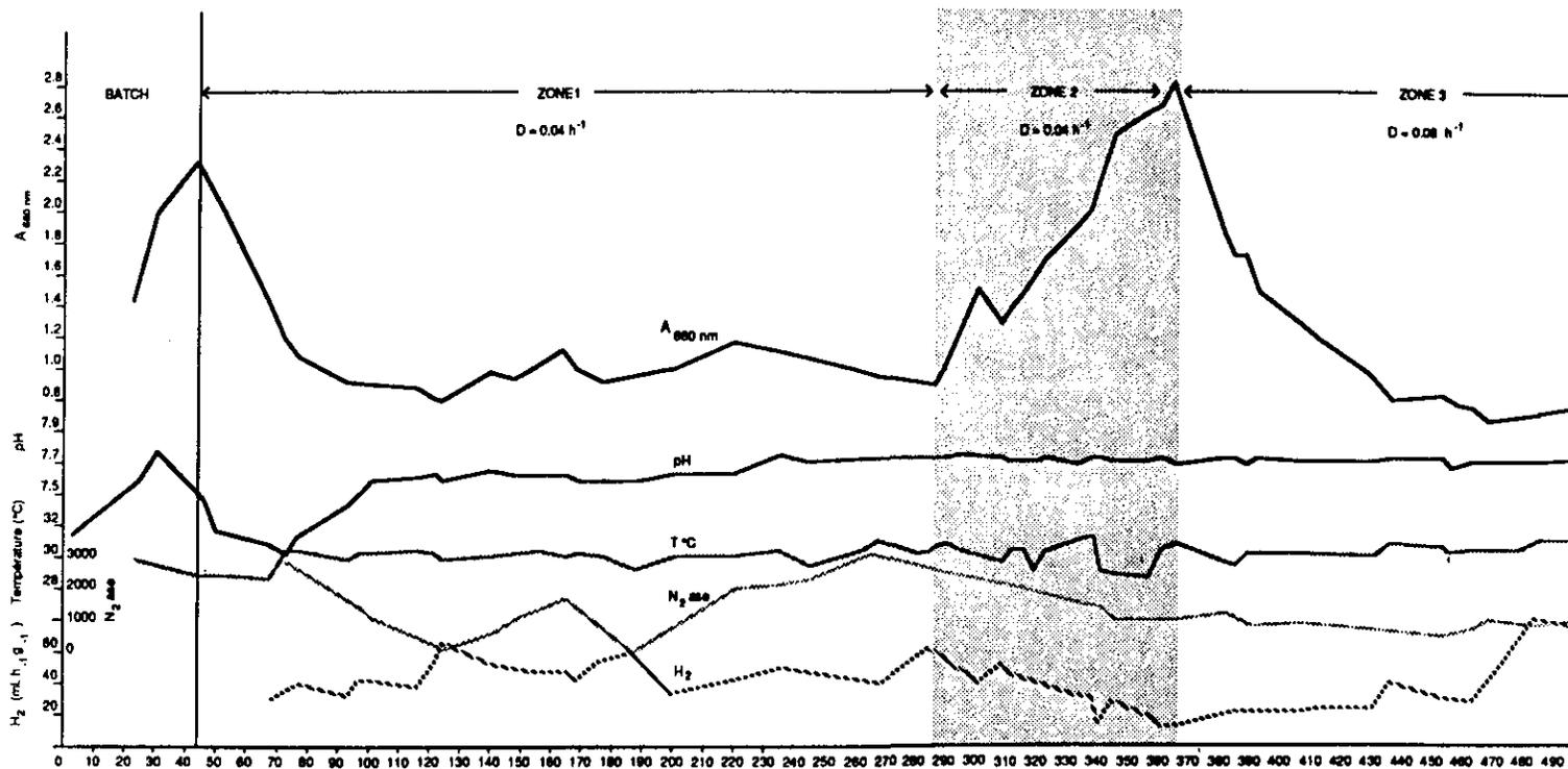
a. Suivi de la concentration bactérienne ( $A_{660\text{ nm}}$ ), du pH, de la température, de l'activité nitrogénase ( $N_2\text{ase}$ ) et de la production d'hydrogène ( $H_2$ ). L'activité nitrogénase est exprimée en  $\text{nmol C}_2\text{H}_4 \cdot \text{h}^{-1} \cdot \text{mg}^{-1}$  psb, la production d' $H_2$  est exprimée en  $\text{ml} \cdot \text{h}^{-1} \cdot \text{g}^{-1}$  psb.
