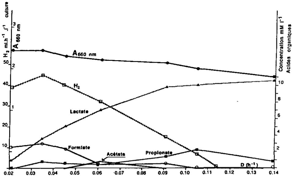
Figure 1 Culture continue de *R. capsulatus*, souche B10, en limitation par le glutamate 7 mM. Concentration initiale en lactate 30 mM. Variations de la production de H<sub>2</sub> (ml · h<sup>-1</sup> · l<sup>-1</sup>), de la densité bactérienne (A<sub>660 nm</sub>), de la concentration en lactate résiduel et en acides formés (mM) en fonction du taux de dilution D (h<sup>-1</sup>).
