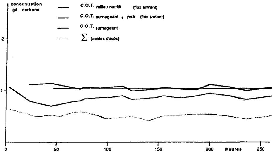
Figure 3 Bilan carboné en limitation d'azote. Le milieu nutritif initial contient soit 2 mM de glutamate ; il est ajouté à taux de dilution constant  $D = 0,04 \text{ h}^{-1}$ . Le carbone COT et les acides organiques totaux, dosés par CLHP, sont exprimés en g de carbone par litre.
