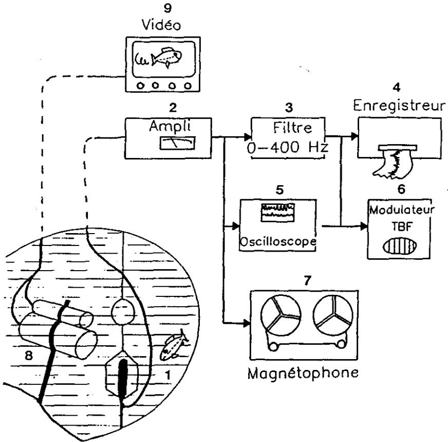
Figure 2. - Bloc diagramme de l'ensemble des matériels électroniques utilisés.
