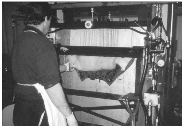
Machine à « dégraisser » les peaux de loup-marin (Photo Andrée Charest)
