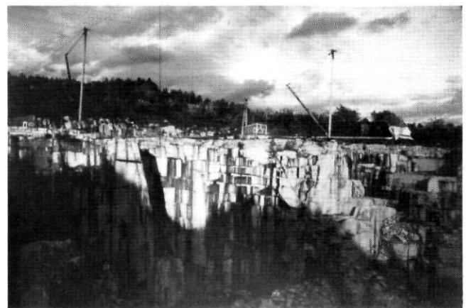
FIGURE 10. Le dispositif orthogonal des diaclases dans les profondes carrières de granite de Barre (Vermont).
