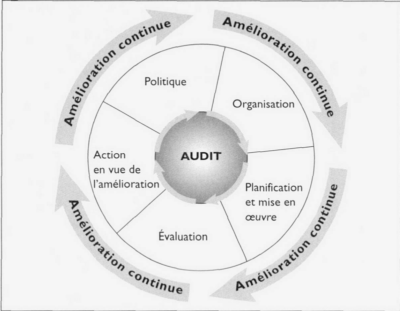
FIGURE 2 PRINCIPAUX ÉLÉMENTS DU SYSTÈME DE GESTION ILO-OSH 2001
