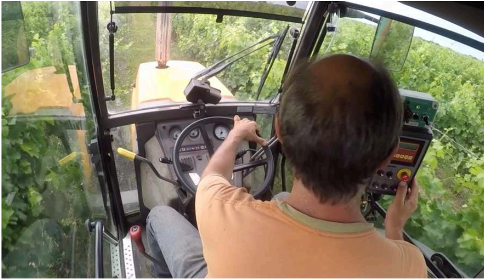
Figure 6. Application de la bouillie à partir de la cabine du tracteur sur lequel le pulvérisateur est embarqué
