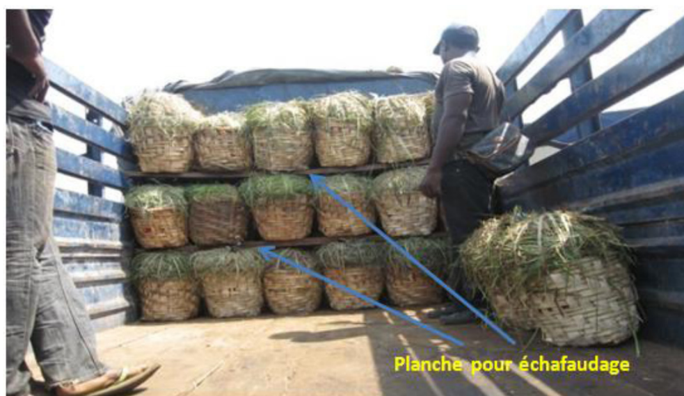
Figure 6. Le chargement par échafaudage.
