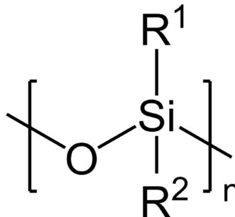
Figure 1. Schéma de la structure d'un siloxane.
