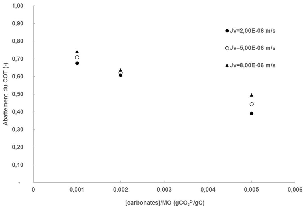
Figure 5. Évolution de l'abattement en COT (carbone organique total) en fonction du ratio [carbonates]/matière organique pour différents flux de perméat.
