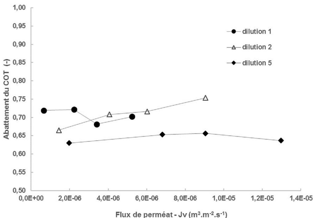
Figure 2. Filtration de l'effluent d'hydrolyse basique – variation de l'abattement en COT (carbone organique total) en fonction du flux de filtration – influence de la dilution.
