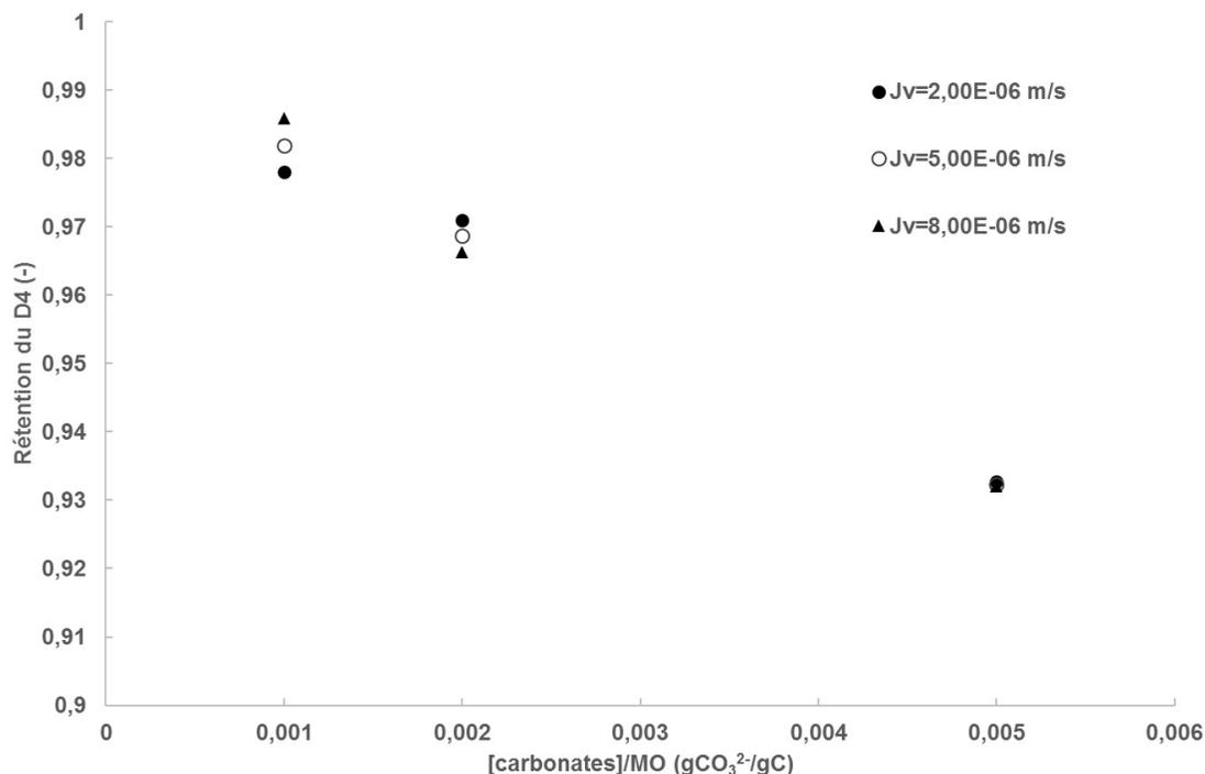
Figure 6. Évolution de la rétention en  $D_4$  en fonction du ratio [carbonates]/matière organique (MO) pour différents flux de perméat.
