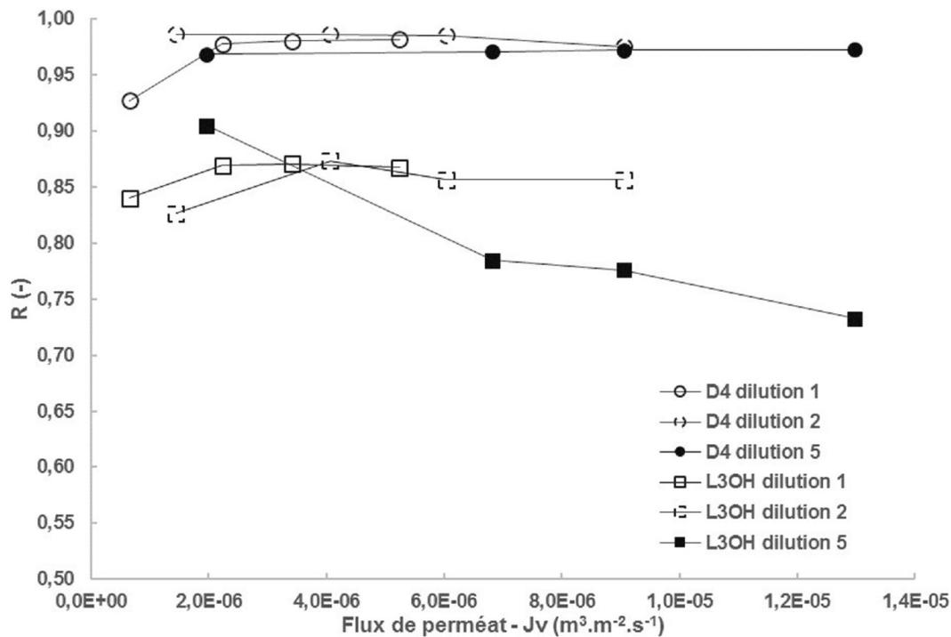
Figure 4. Filtration de l'effluent hydrolyse basique – variation de la rétention du  $D_4$  et de L3OH dans le perméat en fonction du flux – influence de la dilution.
