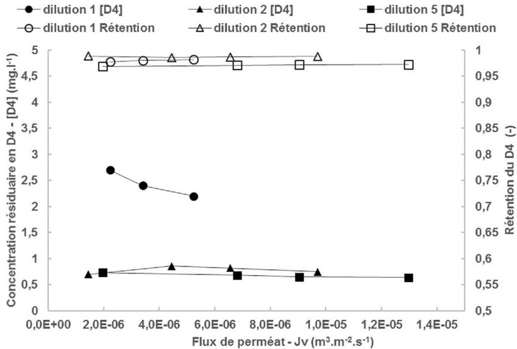
Figure 3. Filtration de l'effluent hydrolyse basique – variation de la rétention du  $D_4$  et de la concentration résiduaire en  $D_4$  dans le perméat en fonction du flux – influence de la dilution.
