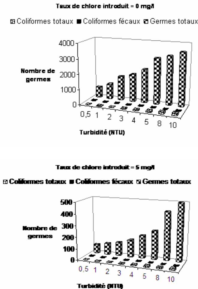
Figure 3. Évolution de la charge bactériologique de l'eau du mélange PK 10 avant et après chloration (5 mg/L) en fonction de la turbidité.
