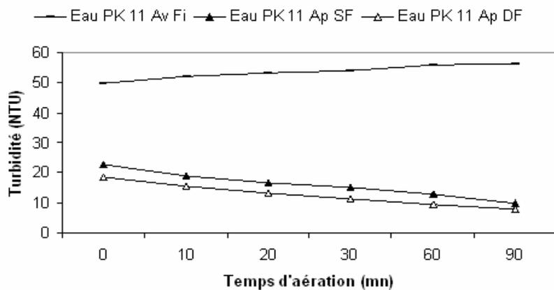
Figure 5. Evolution de la turbidité (NTU) au cours de l'aération, avant et après simple filtration (eau du forage PK11).
