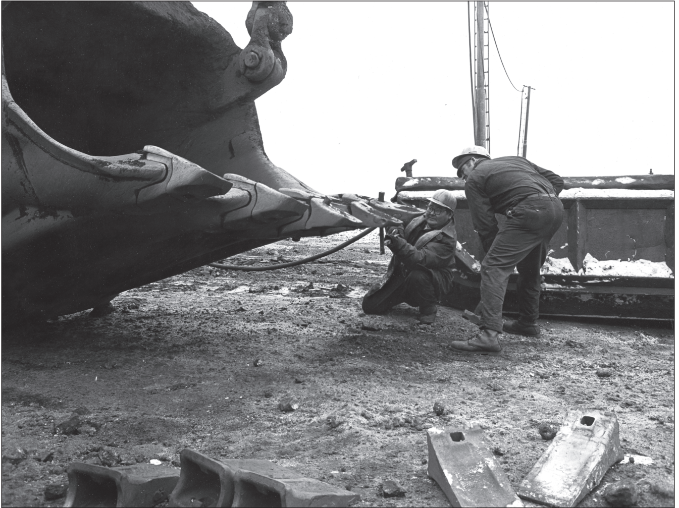
Figure 4 Deux hommes, dont l'ouvrier innu Augustin Vollant, s'affairent à remplacer une dent sur une benne de pelle Marion, près de la mine Redmond, Schefferville (ANQ-C 1969)
