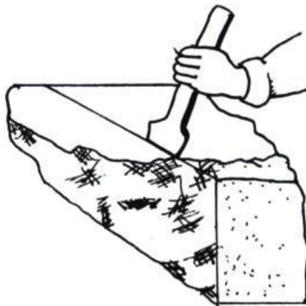
4 À l'aide de la chasse, le maçon dégrossit la pierre et en aplanit grossièrement les surfaces. (réf.: voir ill. 2)
