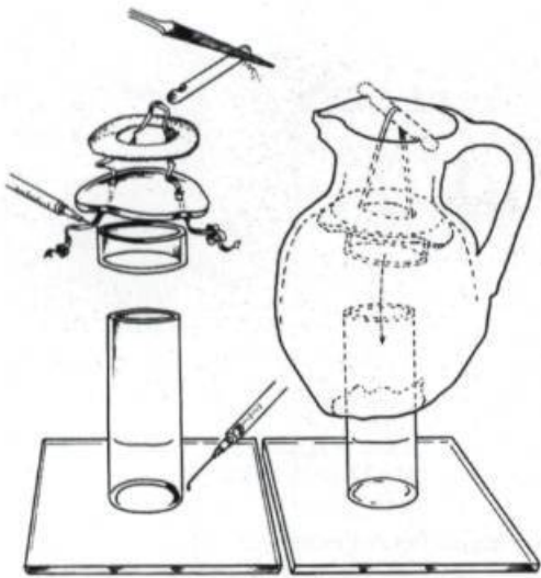
Support de vase fabriqué au Centre de conservation du Québec. (Dessin d'André Bergeron, publié dans Supports pour objets de musée : de la conception à la fabrication ).
