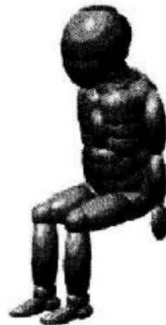
FIGURE I MANNEQUIN HYBRID III-3 ANS (D'APRÈS TNO AUTOMOTIVE, 2003A)
