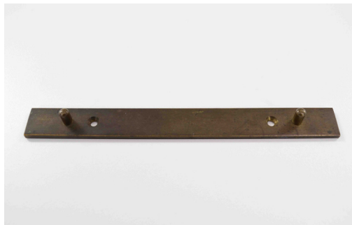
La règle à ergots de Raoul Barré, permettant la stabilisation des dessins sur le plan de travail des dessinateurs. Voir la fiche.
