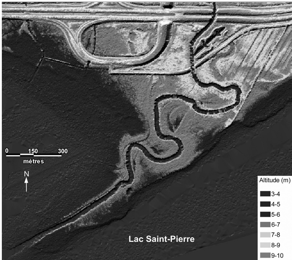
FIGURE 4. Modèle d'élévation de terrain du delta de la Yamachiche à partir de données LIDAR (d'après Morin et al. , 2005).
