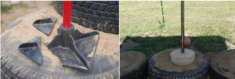
Figure 11. Compacteur pneumatique brisé et, en réponse, un compacteur manuel et un compacteur pneumatique de fortune.
