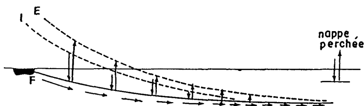
Figure 5 Schéma conceptuel expliquant la formation des dépressions piézométriques. Dans un contexte hydrogéologique à faible perméabilité, l'alimentation permanente à partir des bordures ne suffit pas à compenser le déficit des transferts verticaux Infiltration/Exfiltration. Partant d'un état initial de remplissage maximum (« dernier pluvial Holocène »), la nappe se creuse progressivement pour tendre vers un état d'équilibre dans lequel le très faible flux convergeant vers le centre de la dépression est juste compensé par la reprise évaporatoire (ARANYOSSY, 1988).
