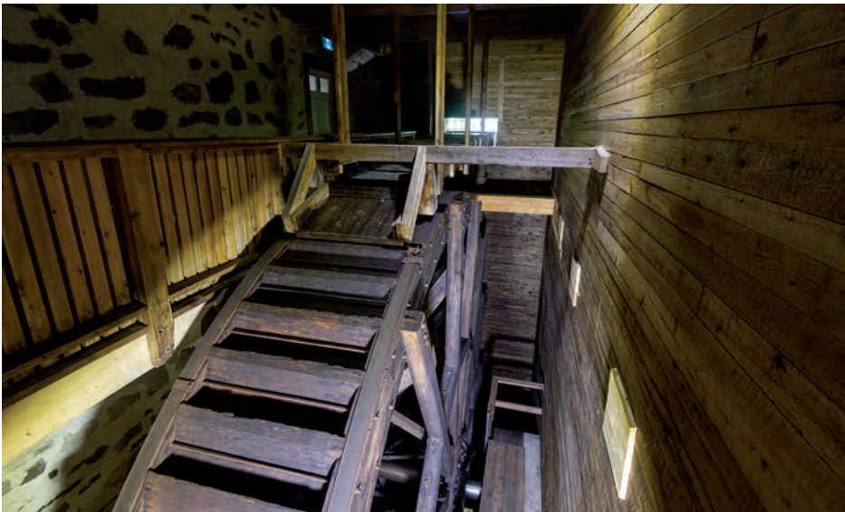
La roue à aubes, fonctionnelle mais désengagée du mécanisme de meulage, pourrait éventuellement servir à produire de l'électricité pour le moulin.
