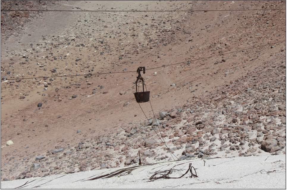
Fig. 4 — Un seau pour le transport du minerai demeure suspendu sur le fil de la remontée mécanique au sommet du volcan Aucanquilcha. Photo : Rodrigo Lorca, Proyecto Arqueológico Alto Cielo.
