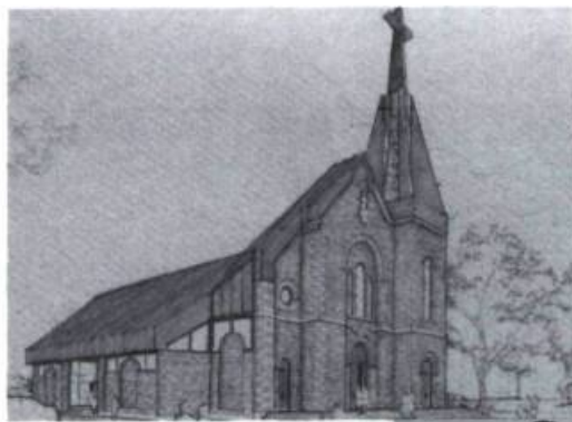
L'intégration de l'ancienne façade au nouveau bâtiment est principalement assurée par le matériau de revêtement: la pierre de taille. (dessin: M. Dallaire arch.)
